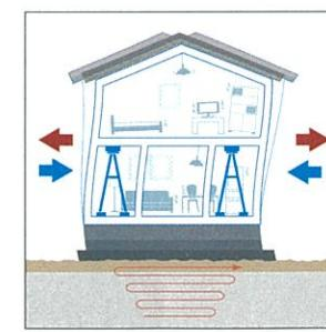
制震装置が地震の揺れを吸収する
